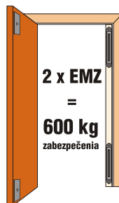
Zabezpečovacia sila: sila tlaku alebo nárazu, ktoréj je zámok schopný odolávať.
